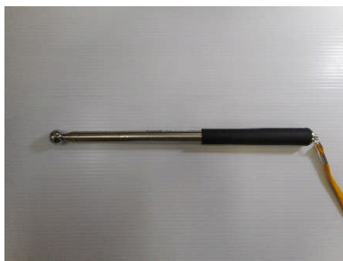
解説 図-5.2.3 触診による調査に用いる器具の例
