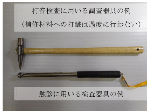
解説 図-4.2.2 触診や打音による調査に用いる器具の例
