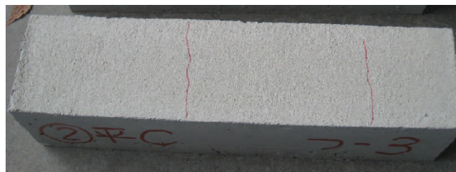
(3) 暴露3年でのひび割れの状況
