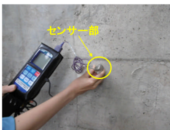
図 2 接触式表面温度計を用いた表面温度の測定例
