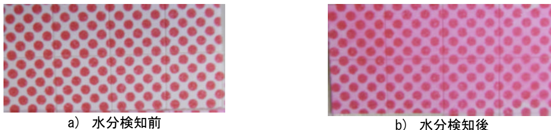
図 1 水分検知による滲み
