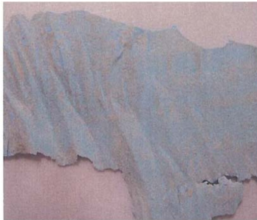
写真 6-1 塗膜の剥離面への粉塵の付着
