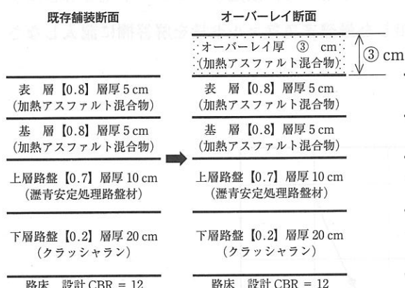
図 2 - 3 オーバーレイ舗装補修断面
